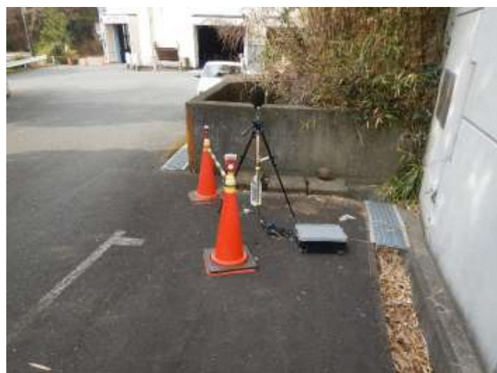
騒音振動調査状況
