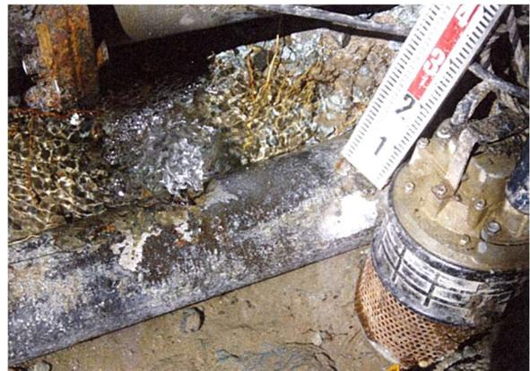
老朽化した管路において発生した漏水事故
