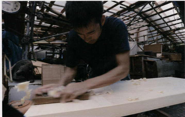
町内の精肉店から発注された143×55cmの大きなまな板。まな板には最適といわれるイチョウの一枚板を使っている。何種類ものカンナを使い分け、丁寧に仕上げている。
